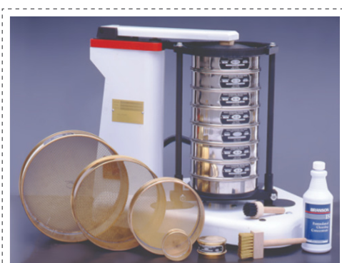
Figura 25: Agitador y juego de tamices Tyler
